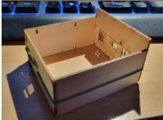
3. Die Wände zusammensetzen. Eventuell mit einem Gummiring fixieren.
