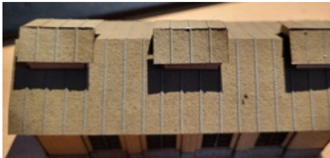
12. Unterbau und Dachplatten der Hutzen aufkleben. Glue on the substructure and roof panels of the scoops.
