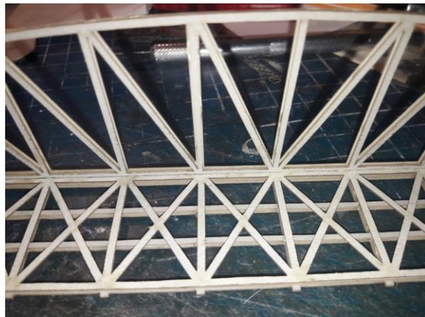
4. beidseitig 0,3mm Innenteil einkleben/Glue in 0.3mm inner part on both sides
